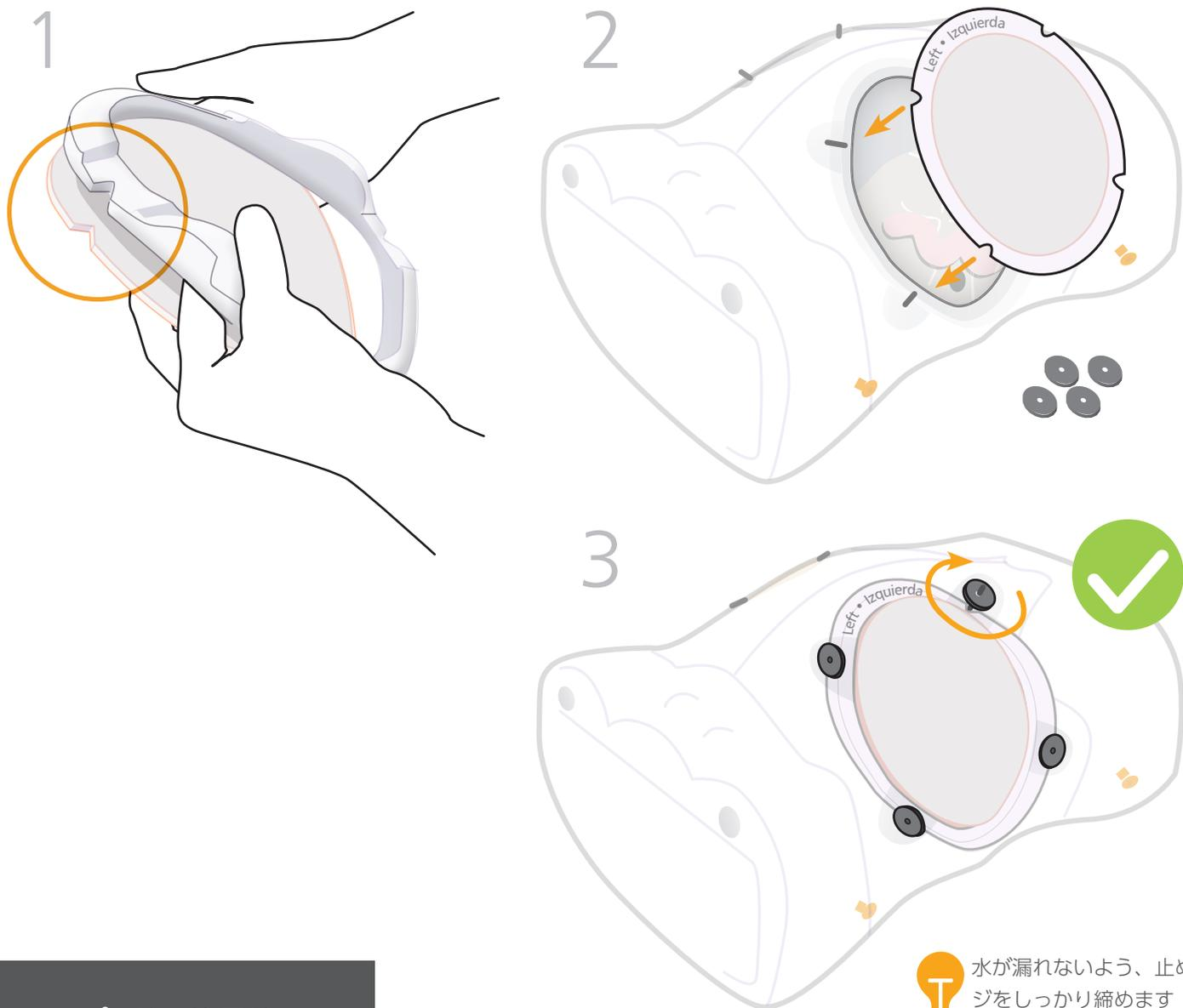
**T** 水が漏れないよう、止めネジをしっかり締めます
