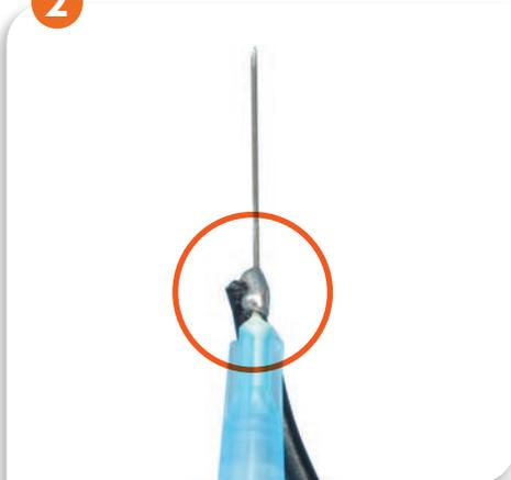
注射器の針の部分にリード線が接続されていることを確認してください。
