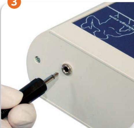
注射器のリード線の先のプラグをフィードバック装置背面の丸いソケットに差し込んでください。
