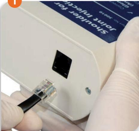
バッテリーテストが完了したら、モデルに接続されているケーブルをフィードバック装置背面の黒いソケットに差し込んでください。
