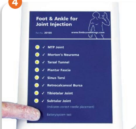
フィードバック装置パネルの下部にある「Battery/system test」ボタンを押してください。全てのライトが点灯します。
