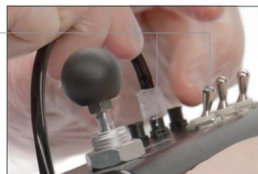
3. ご使用後は必ずスイッチを「OFF」にし、脱気を行ってください。加圧状態での保管は故障原因となります。
